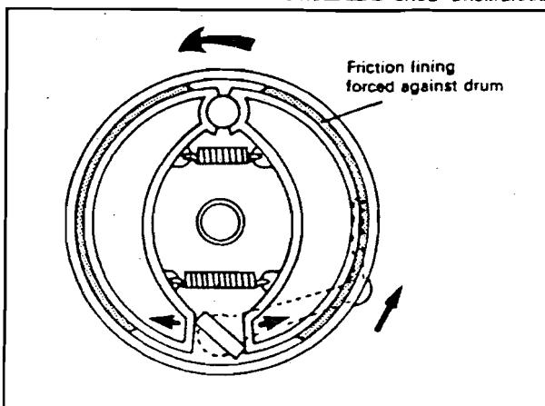
OPERATION OF A TWIN LEAD SHOE - DRUM BRAKE
